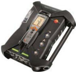
Блок анализатора testo 350 оснащен сенсором O<sub>2</sub>, вкл. сенсор дифф. давления, разъемы для зондов температуры (т/п Тип К, NiCr-Ni и т/п Тип S, Pt10Rh-Pt), разъем для подключения к шине данных Testo, перезаряжаемый аккумулятор, встроенный зонд воздуха, идущего на горение (NTC), триггерный вход, встроенную память, USB-интерфейс, дооснащенный до 6 сенсоров газа CO, CO<sub>низ</sub>, NO, NO<sub>низ</sub>, NO<sub>2</sub>, SO<sub>2</sub>, CO<sub>2</sub> NDIR, CxHy и H<sub>2</sub>S
