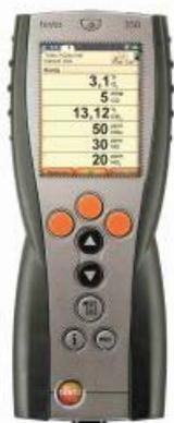
Управляющий модуль testo 350, предназначен для управления блоком анализатора и отображения данных измерений; вкл. перезаряж. аккумулятор, внутреннюю память прибора, USB-интерфейс и разъем для подключения к шине данных Testo
