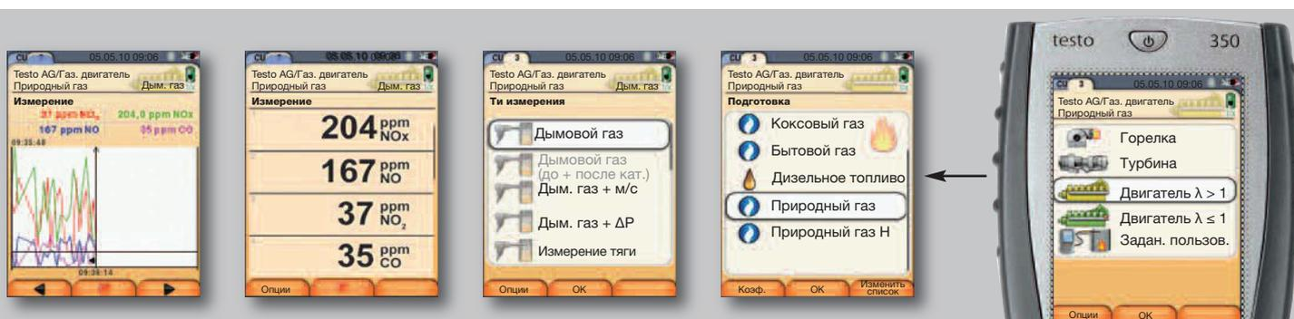
5. Документирование ← 4. Измерение ← 3. Выбор типа измерения ← 2. Выбор топлива ← 1. Выбор области применения
