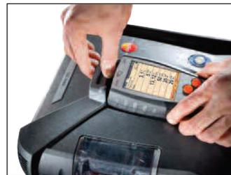
Управляющий модуль просто "защелкивается" в блок анализатора
