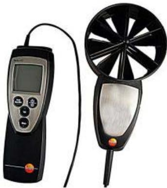
testo 417-2, анемометр с выносной крыльчаткой D 100 мм, длина кабеля 1,5 м; для измерения температуры и скорости, с батарейкой и заводским протоколом калибровки
