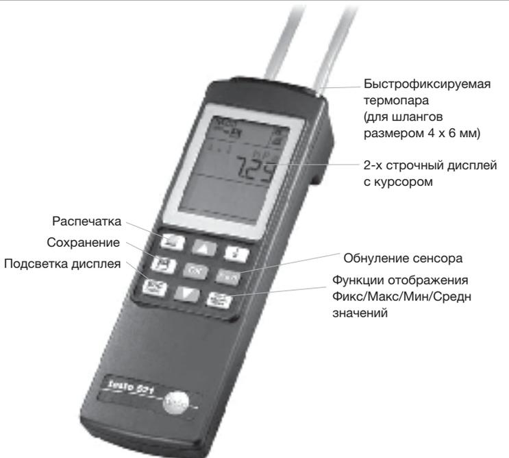
**1** testo 521-1, дифференц. манометр от 0 до 100 гПа (погрешность 0,2% от полной шкалы) вкл. батарейку и заводской протокол калибровки
