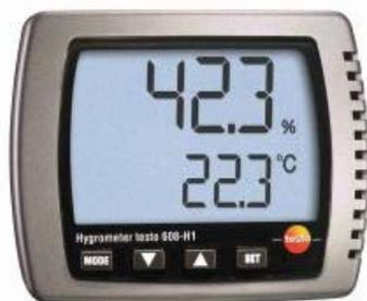
Гигрометр testo 608 H-2 для измерения влажности/температуры/температуры точки росы, с LED-сигнализацией, батареейкой и протоколом калибровки
