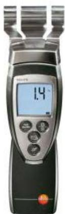
testo 616, прибор для измерения влажности древесины и строительных материалов, вкл. батарейку и протокол калибровки
