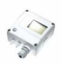
testo 6321 трансмиттер дифференциального давления, погрешность ±1.2% от измеряемого диапазона, автоматическая настройка «нулевой точки», возможность выбора измерительных диапазонов от 100 Па до 2000 гПа, возможность выбора сигнальных аналоговых выходов, внешний цифровой интерфейс для настройки и параметризации, опциональный дисплей.
