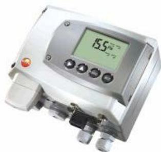
testo 6351 трансмиттер дифференциального давления с функцией расчета скорости потока, погрешность  $\pm 0.8\%$  от измеряемого диапазона, автоматическая настройка "нулевой точки", возможность выбора измерительных диапазонов от 50 Па до 2000 гПа, возможность выбора сигнальных аналоговых выходов, внешний цифровой интерфейс для настройки и параметризации, опциональный дисплей, вывод данных во всех единицах измерения давления и скорости потока
