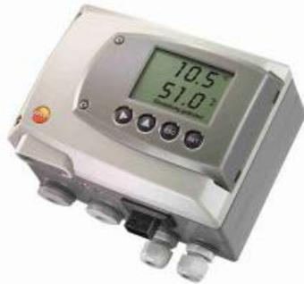
testo 6651 трансмиттер температуры/влажности для критических условий окружающей среды, погрешность до  $\pm 1.7$  %ОВ (зависит от типа зонда), доступен выбор сигнальных аналоговых выходов, опциональный дисплей, опциональный Ethernet-модуль, опциональные реле, внешний цифровой интерфейс для настройки и параметризации, 2 аналоговых выхода.
