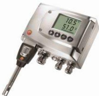
testo 6681 Промышленный трансмиттер температуры/влажности, погрешность до  $\pm 1.0$  %ОВ (зависит от типа зонда), доступен выбор сигнальных аналоговых выходов, опциональный дисплей, опциональный Ethernet-модуль или модуль Profibus DP, вывод данных во всех единицах измерения влажности, опциональные реле, внешний цифровой интерфейс для настройки и параметризации, 2 аналоговых выхода, опциональный 3-й аналоговый выход
