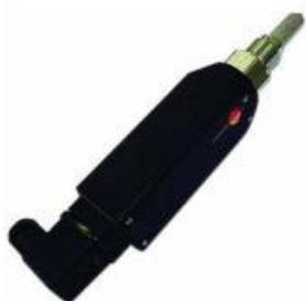
testo 6741 трансмиттер точки росы, диапазон измерений до  $-45^{\circ}\text{C}$ тр, без дисплея, тип соединения G1/2, аналоговый сигнальный выход 4...20 mA, опциональный разъем сигнального модуля с двумя переключаемыми выходами
