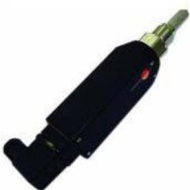
testo 6742 трансмиттер точки росы, диапазон измерений до -45°Cstr, без дисплея, тип соединения NPT1/2, аналоговый сигнальный выход 4...20 mA, опциональный разъем сигнального модуля с двумя переключаемыми выходами
