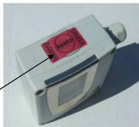
Преобразователь дифференциального давления Testo 6351 и Testo 6381
