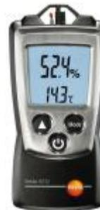
Рис. 3. Прибор комбинированный Testo 610
