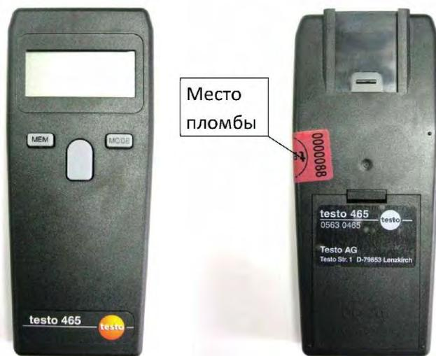
Рисунок 2. Фототахометр электронный Testo-465
