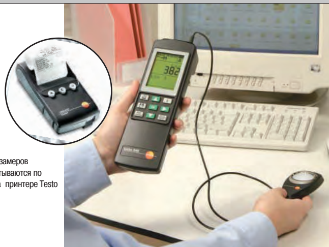
Измеряет освещенность на рабочем месте
