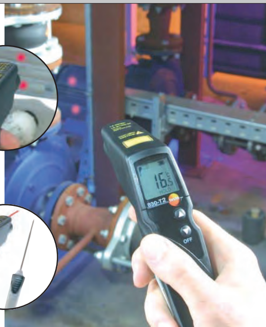
Мониторинг температурного режима, например, насоса
