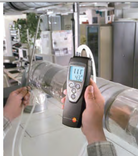
Измерение скорости потока воздуха
