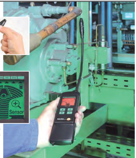
Быстрое и надежное определение утечек в системах охлаждения и тепловых насосах
