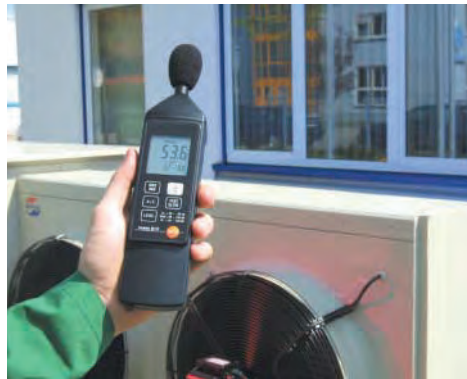
testo 815, мониторинг уровня шума в системах вентиляции
