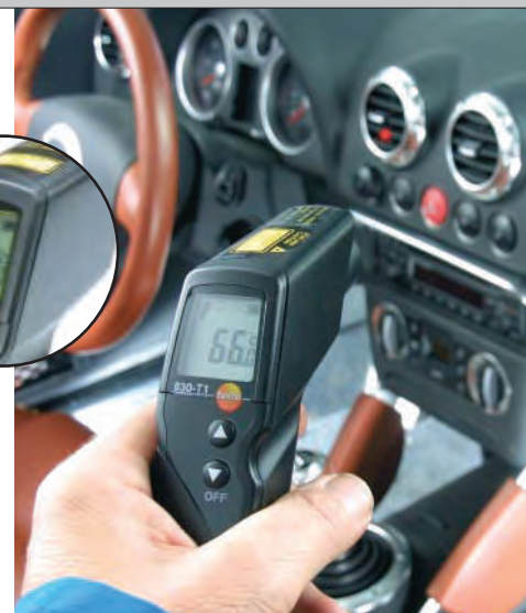
Проверка температуры у вентилятора
