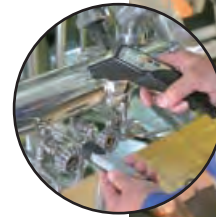
Измерение температуры дополнительным зондом
