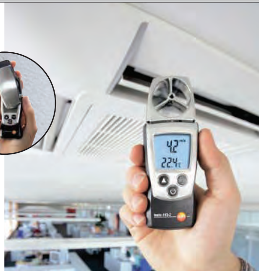
Измерение скорости потока на выходе воздуховода крыльчаткой D 40 мм
