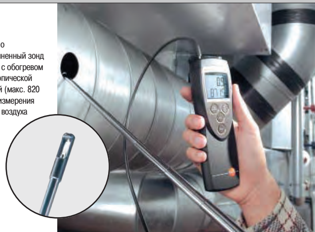
testo 425 используется, например, для мониторинга объемного расхода воздуха в вытяжных каналах
