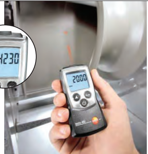
Бесконтактно измерение скорости вращения вентилятора
