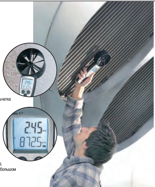
Измерение объемного расхода с помощью крыльчатки диаметром 100 мм на выходах воздуховодов
