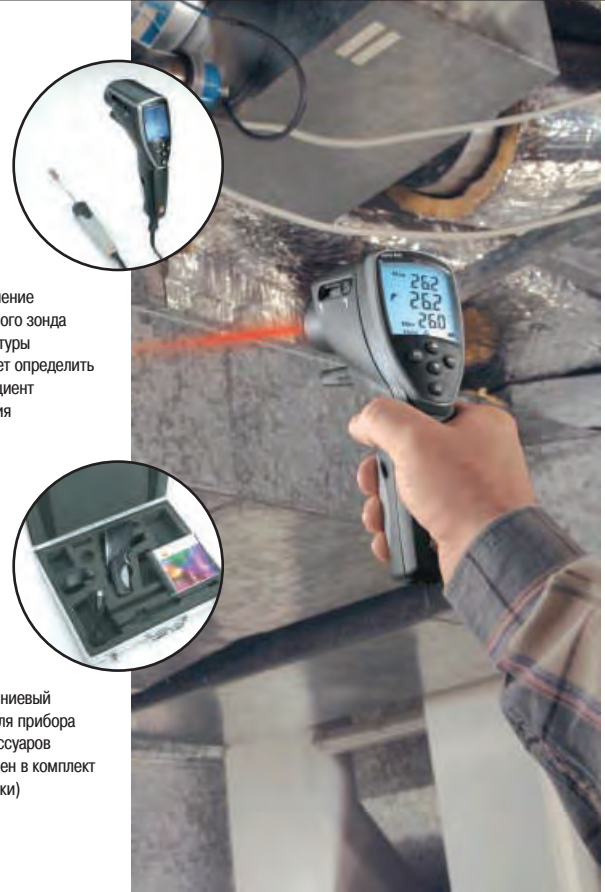
Проверка температуры воздуховодов
