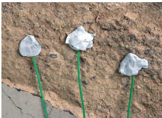
Зонд для определения коэффициента теплопотерь измеряет температуру на внутренней поверхности стены в 3-х точках.
