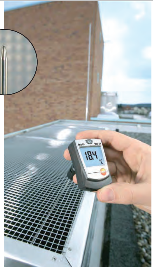
Измерение температуры воздуха на вентиляционной решетке
