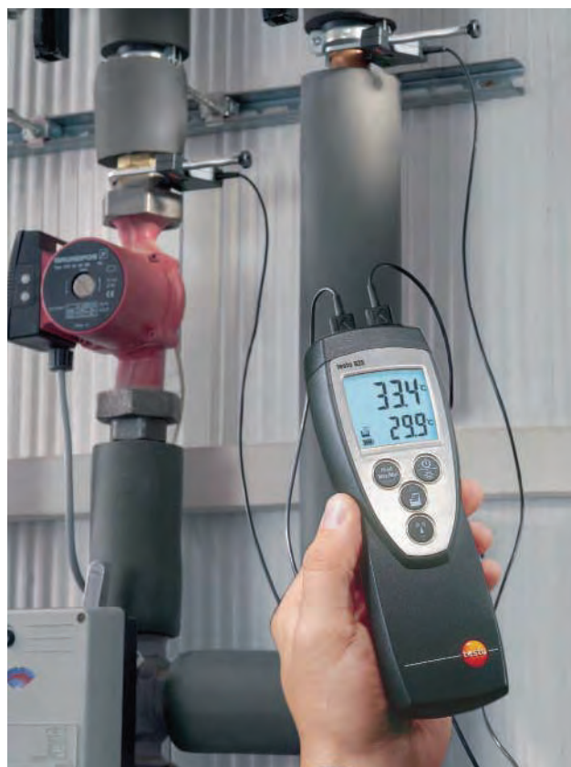
Одновременное измерение 2-х температур на входе и выходе котла с расчетом дифференциальной температуры
