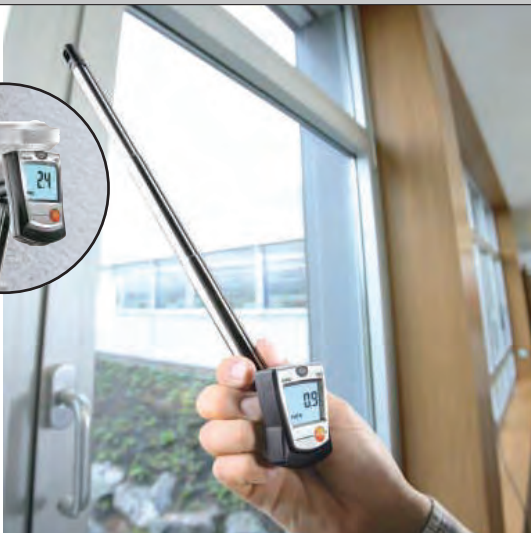
Измерение скорости воздуха у негерметично закрытых окон
