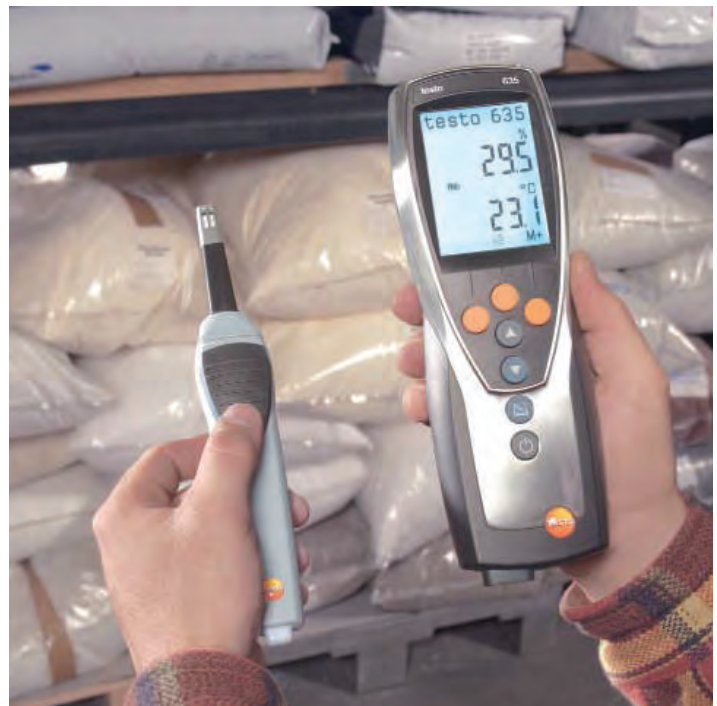
Измерения температуры и влажности на складах
