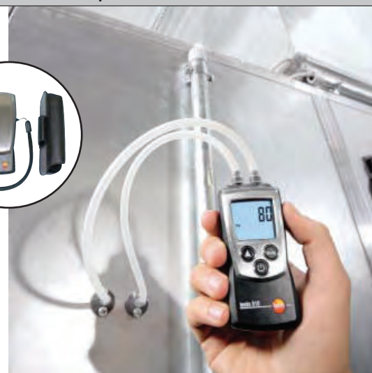
Измерение дифференциального давления на фильтрах
